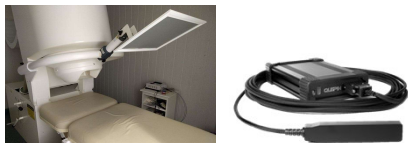
(a) CTF MEG (b) QUSPIN QZFM OPM Figure 1. MEG technologies
